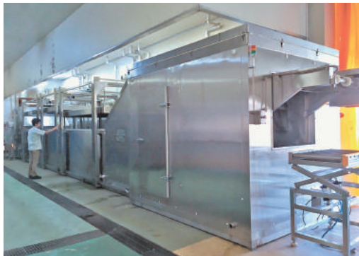
山形県の食品工場に導入された Gondola 連続式液体凍結装置
